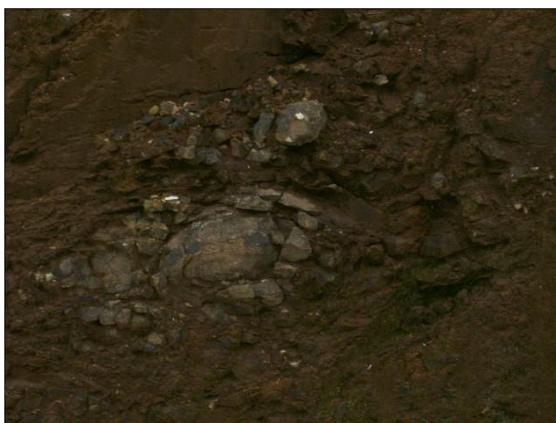
Figura 47 – Característica estrutura de alteração intempérica por esfoliação esferoidal junto aos basaltos da Formação Serra Geral.
